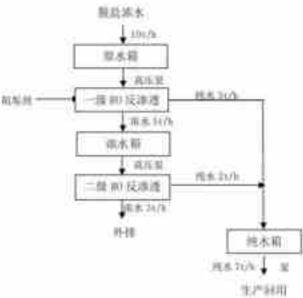
图 6.1-4 脱盐水浓度深度回用工艺流程图
