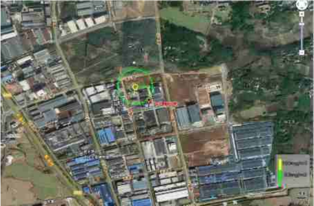
图 5.3-1 盐酸储罐发生泄漏影响范围预测图
