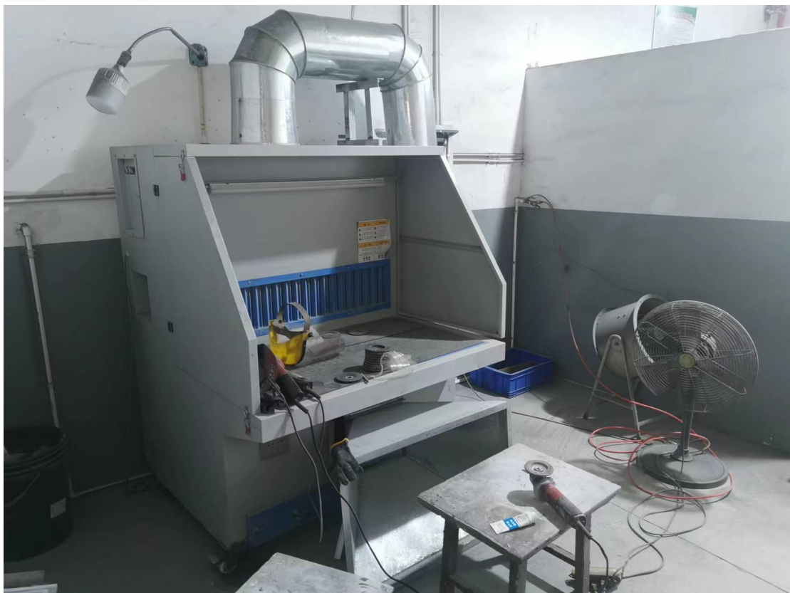
打磨工作台及废气收集装置
