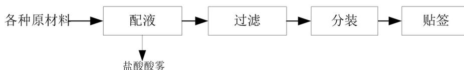
图 2-5 浓缩洗涤液制备工艺流程及产污环节图
