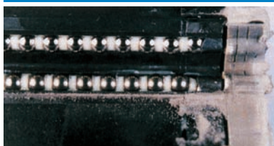
钢球滚动面上没有发现异物的落入
