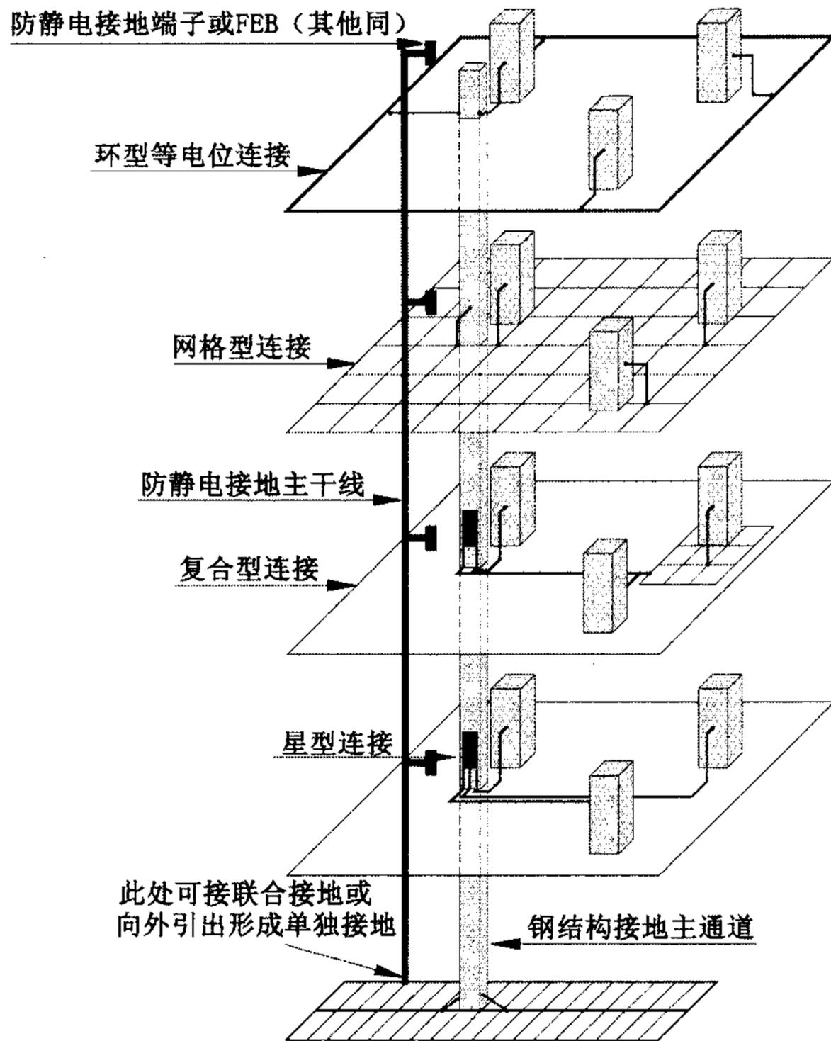
图 2 防静电接地系统典型布置
