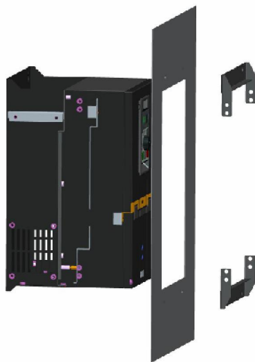
图3-4. ASB700/ASB700S变频器钣金结构穿墙式安装图
