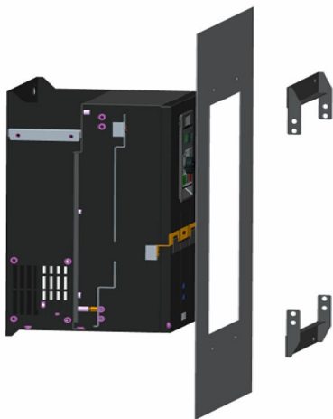
图3-4. ASB500变频器钣金结构穿墙式安装图
