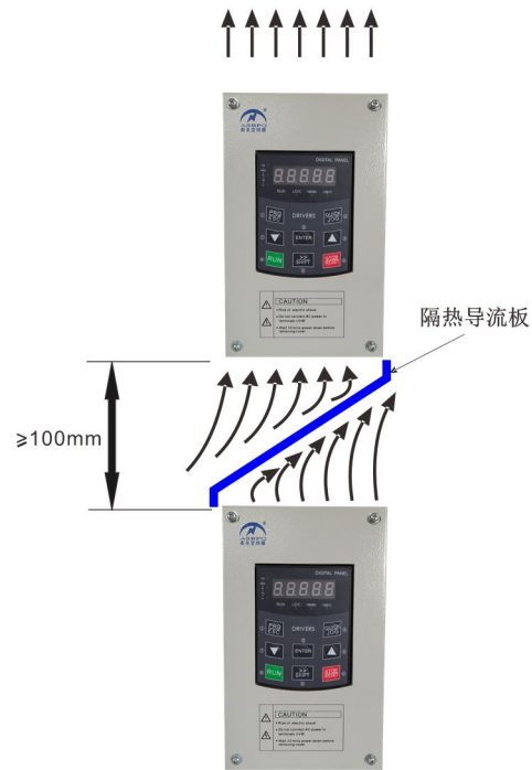
图1-5. ASB53XH变频器安装示意图
